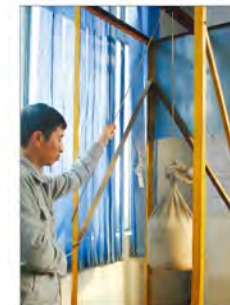
Impact Load Test 冲击测试
