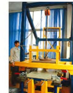
Rolling Load Test 滚动载荷测试
