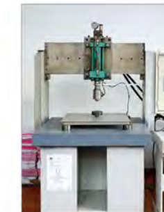
Concentrated Load Test 集中载荷测试
