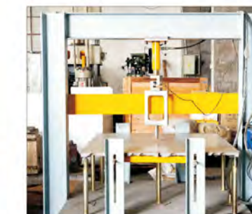
Design Load Test 设计压力载荷测试
